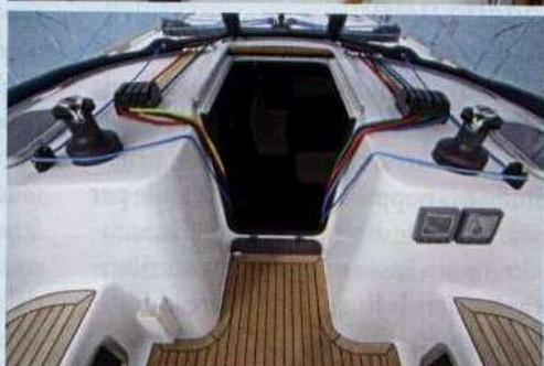
Sopra, la zona d'ingresso garantisce un appoggio sicuro per lavorare ai winch delle drizze.
