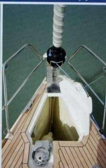
A lato, il pozzo della catena è stretto e profondo, il salpancora elettrico è manovrabile anche con il portello chiuso. A sinistra, il pozzetto con il tavolo in teak aperto. Le sei sedute sono confortevoli, ma la bussola è distante dalle ruote e di conseguenza poco leggibile.
